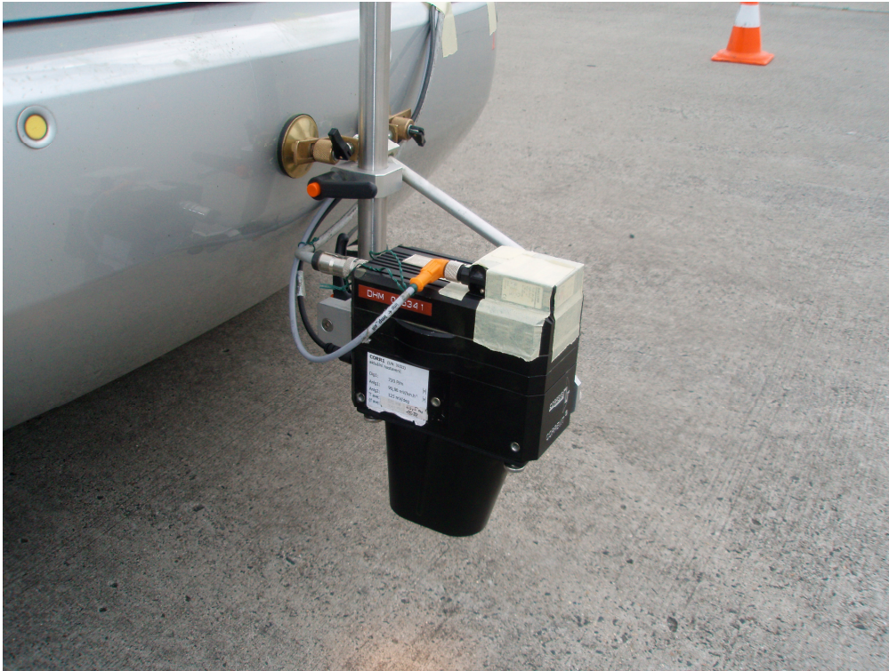
Obrázek. 5: Snímač Correvit® S-CE upevněný na zadním nárazníku
