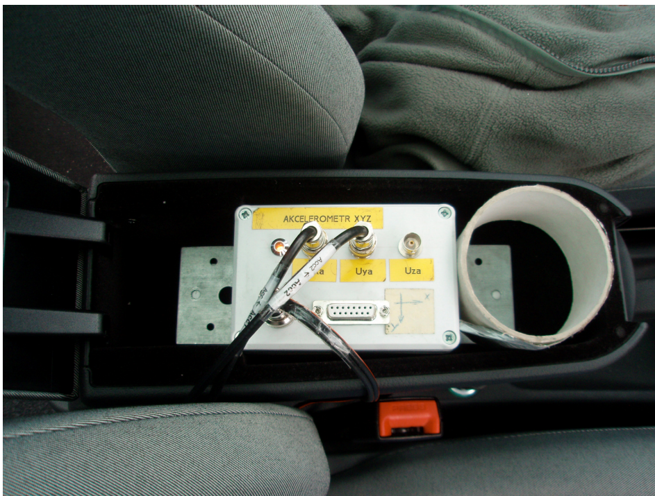
Obrázek 10: Snímač zrychlení pevně uchycený ve schránce mezi předními sedačkami
