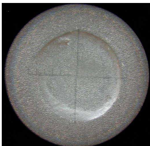
Obr. 7-51: Povrch bodového svaru – vz. St.1
