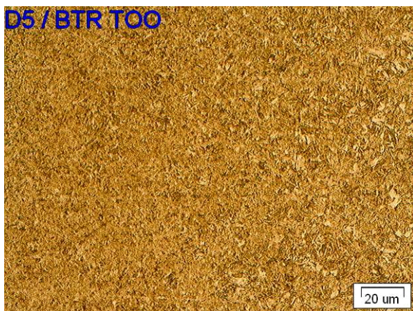
Obr. 7-40: Tepelně ovlivněná oblast – vz. D5 (BTR165)
