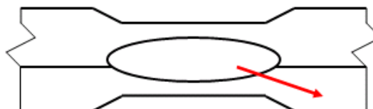
Obr. 7-26: Směr měření linie mikrotvrdoměří heterogenního svarového bodu
