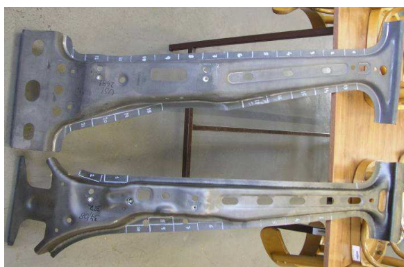
Obr. 5-1: Díly B-sloupku (horní – USIBOR 1500, dolní – BTR165)
