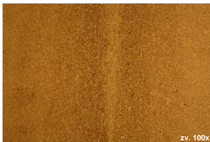
Obr. 7-2: Mikrostruktura materiálu BTR165 – vz. BTR 25-08-3
