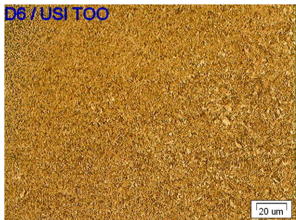
Obr. 7-41: Tepelně ovlivněná oblast – vz. D6 (USIBOR 1500)
