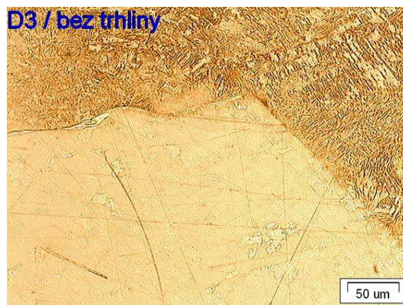
Obr. 7-32: Hranice SK-TOO bez trhlin – vz. D3
