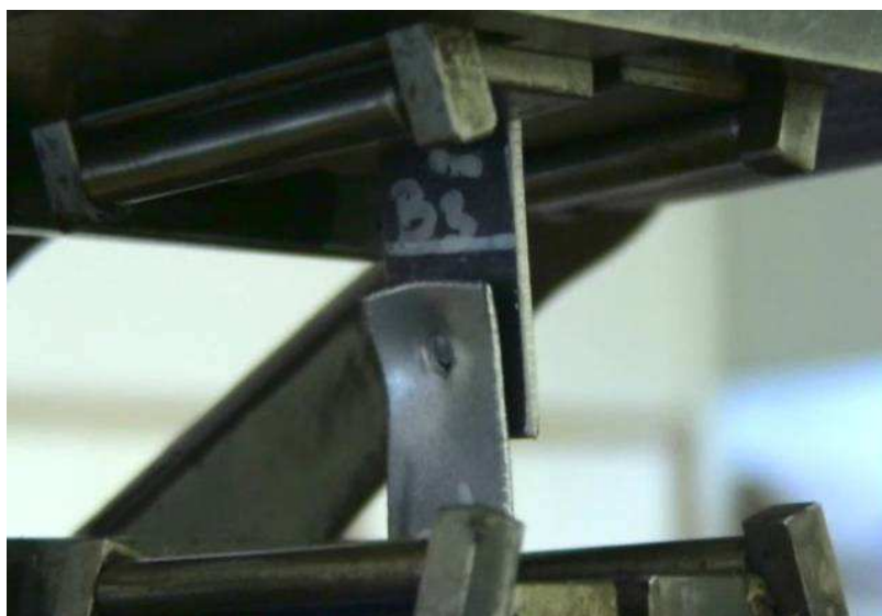
Obr. 7-19: Tahová zkouška stříhem u bodového odporového svaru
