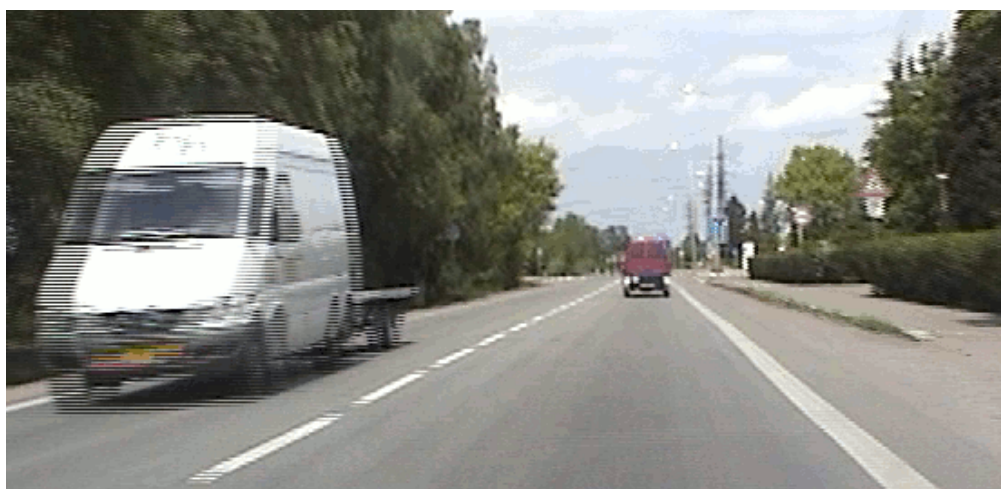
Obr. 9: Efekt prokládání pulsů na rychle se pohybujícím objektu
