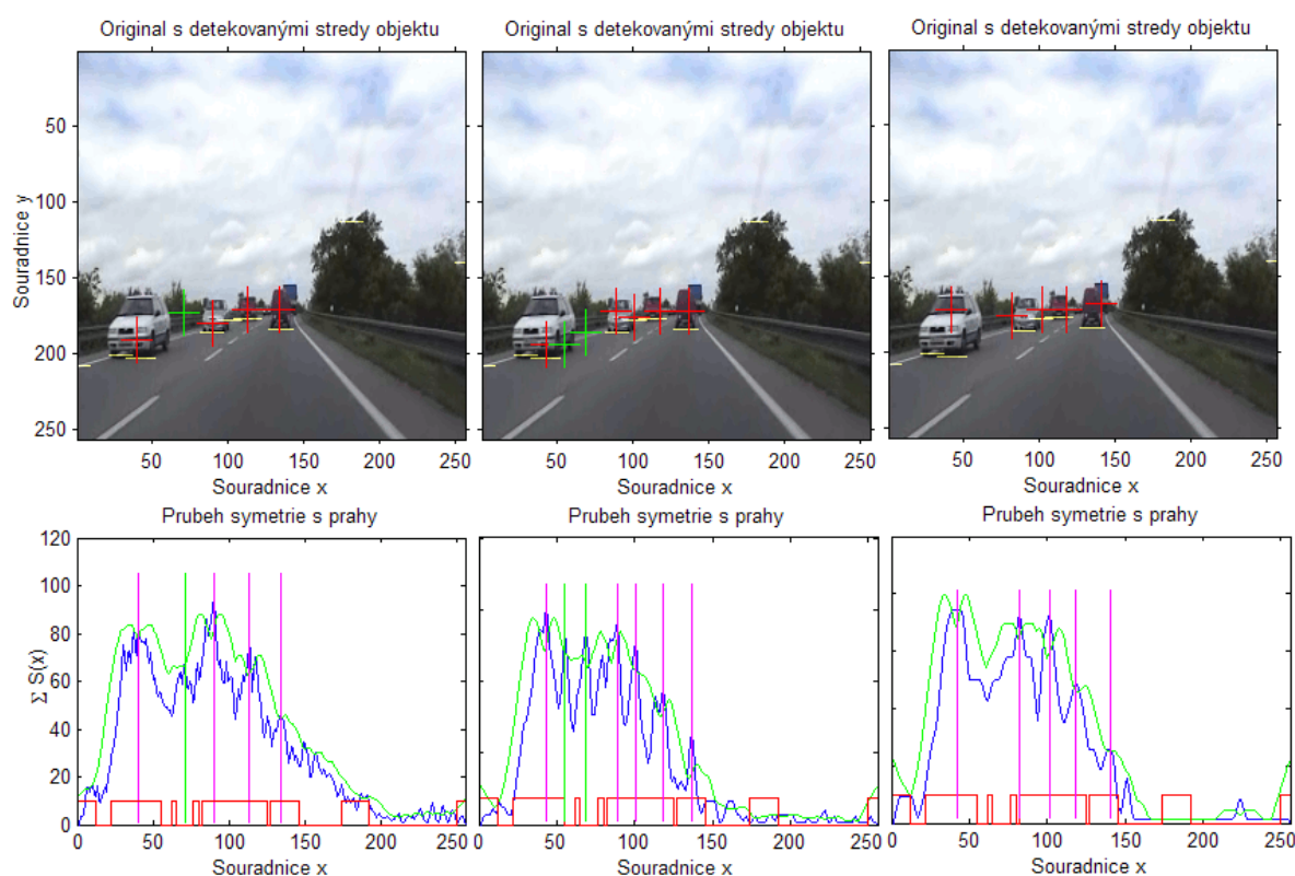
Obr. 71: Průběh symetrie v obraze pro velikosti akumulátoru 256^2 (3,7 s), 128^2 (820 ms) a 64^2 (185 ms) bodů (červenými kříži jsou označeny úspěšně detekované objekty, zelenými kříži další maxima symetrie)
