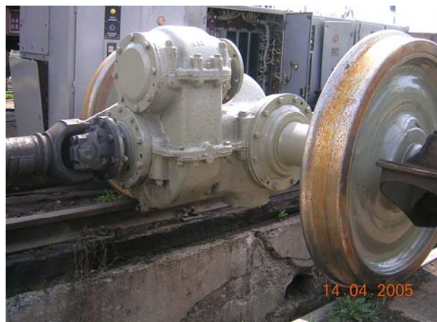
Obr. 7.4 Převodovka NP 20 a) čelní pohled, b) boční pohled
