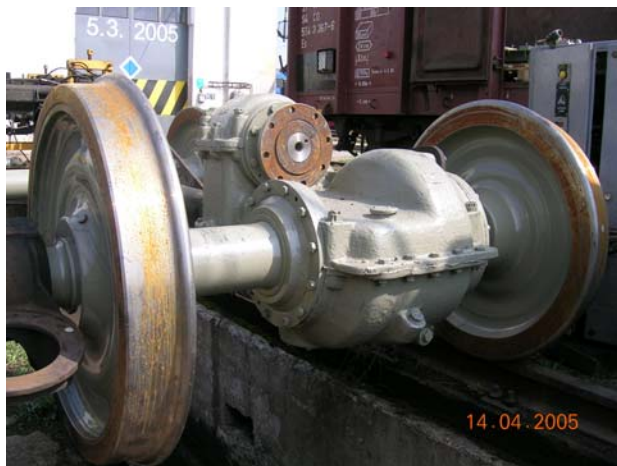
Obr. 7.4 Převodovka NP 20 a) čelní pohled, b) boční pohled
