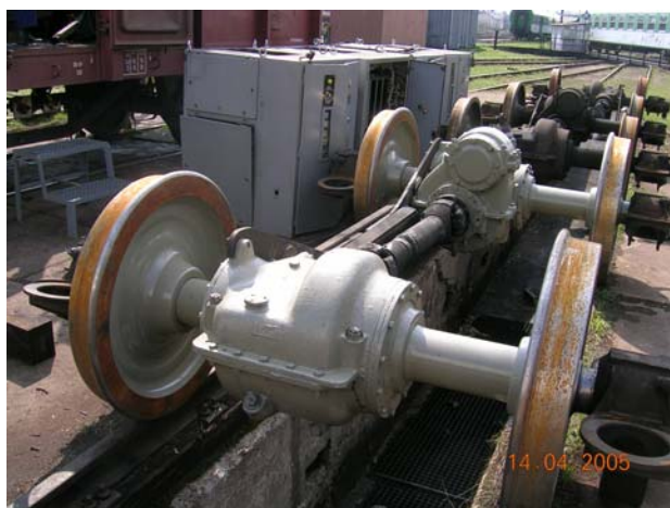
Obr. 7.5 Převodovka NK 20 pohled a) čelní pohled, b) boční pohled
