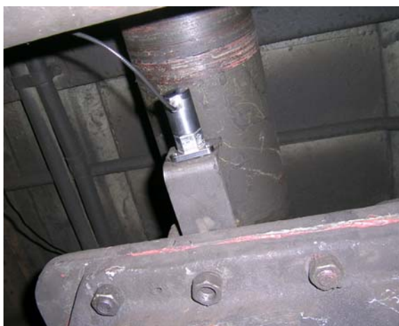
Obr. 8.7 Upevnění snímačů při měření a) ve směru jízdy, b) kolmo ne směr jízdy
