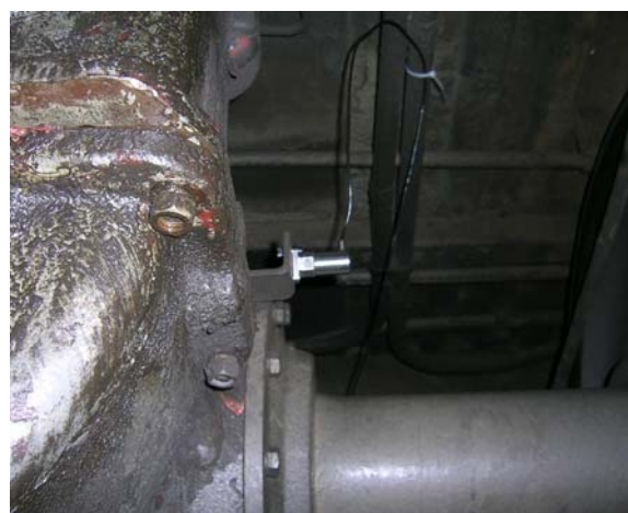
Obr. 8.7 Upevnění snímačů při měření a) ve směru jízdy, b) kolmo ne směr jízdy
