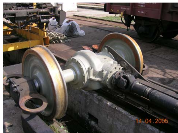
Obr. 7.5 Převodovka NK 20 pohled a) čelní pohled, b) boční pohled
