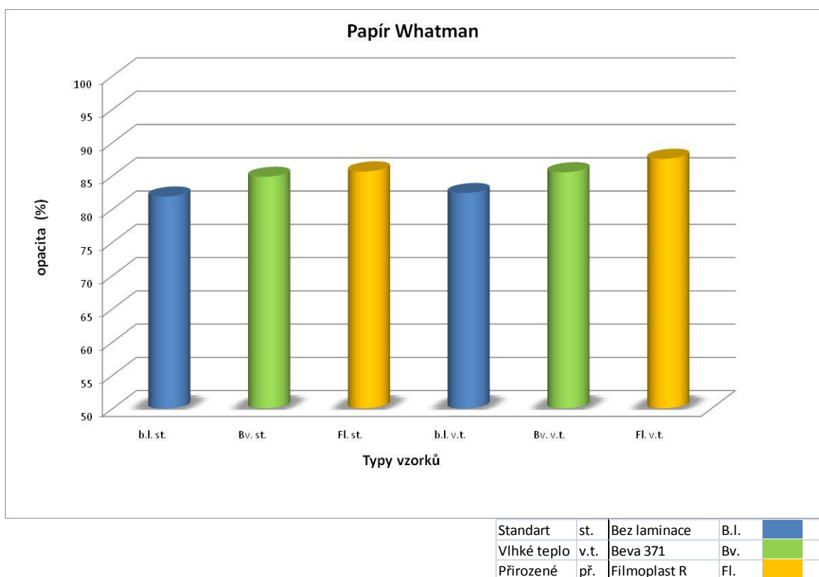
Graf 13: Srovnání změn opacity mezi chromatografickým papírem Whatmanem laminovaným Filmoplastem R a Bevou 371 po procesech urychleného stárnutí.
