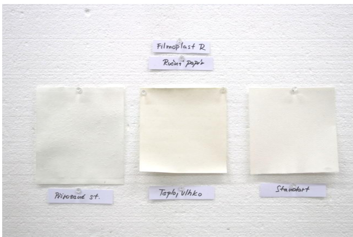
Obr.č. 2: Stav vzorků ručního papíru zpevněných Filmoplastem R po dvou typech urychleného stárnutí, ve srovnání s nestárnutým vzorkem.
