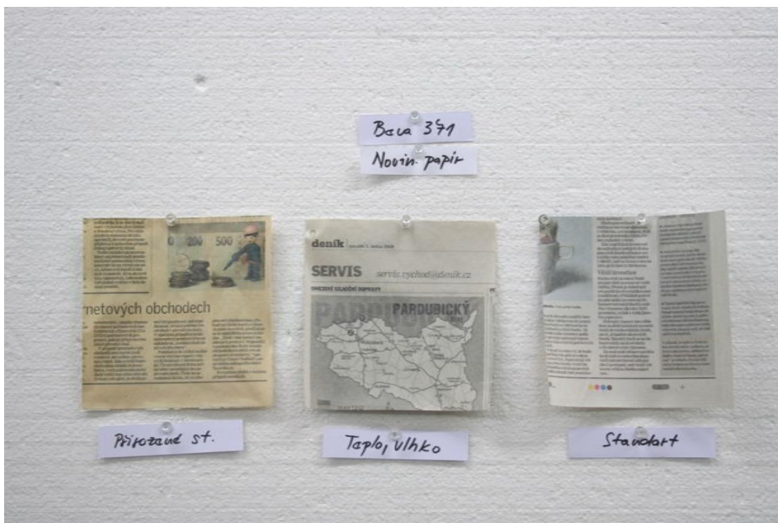
Obr.č. 8: Stav vzorků novinového papíru zpevněných Bevou 371 po dvou typech urychleného stárnutí, ve srovnání s nestárnutým vzorkem.
