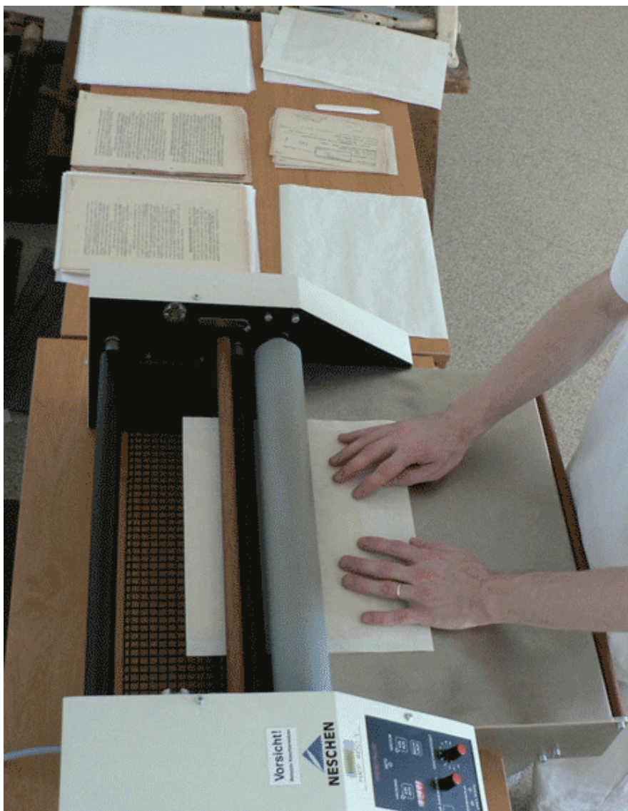
Obr.č. 16: Metoda laminace fólií Filmoplast R na bubnovém laminátoru od firmy Neschen. Foto: Národní archiv 57
