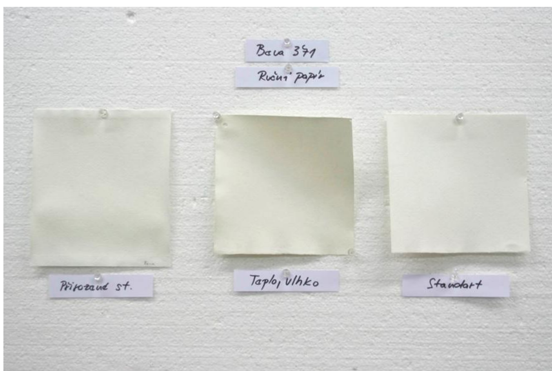
Obr.č. 7: Stav vzorků ručního papíru zpevněných Bevou 371 po dvou typech urychleného stárnutí, ve srovnání s nestárnutým vzorkem.
