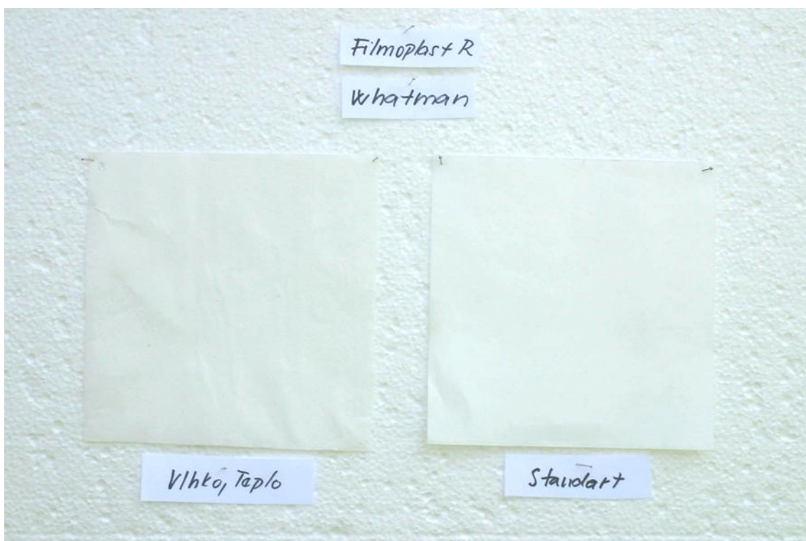
Obr.č. 4: Stav vzorků papíru Whatman zpevněných Filmoplastem R po dvou typech urychleného stárnutí, ve srovnání s nestárnutým vzorkem.
