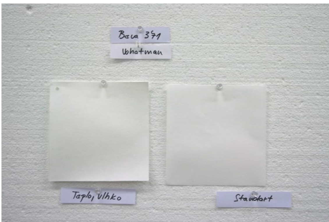
Obr.č. 9: Stav vzorků papíru Whatman zpevněných Bevou 371 po dvou typech urychleného stárnutí, ve srovnání s nestárnutým vzorkem.
