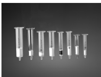
Obrázek 7. Různé typy SPE kolonek
