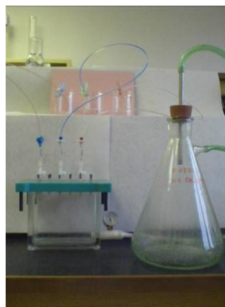
Obrázek 8. Zautomatizování extrakce tzv. Manifoldem
