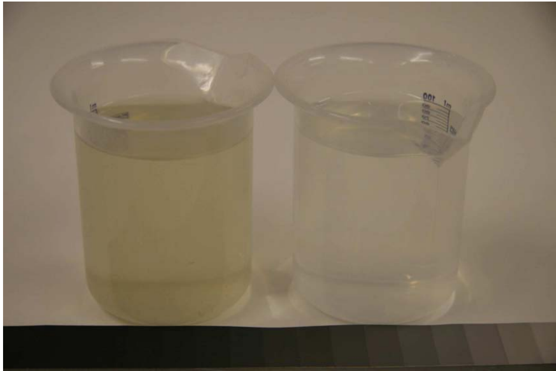
Obr.č.41 etanol po lázni a čistý etanol
