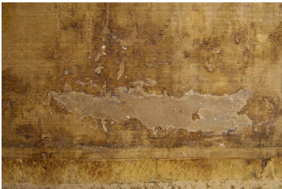
Obr.č.34 přední deska napadená červotočem po vytmelení
