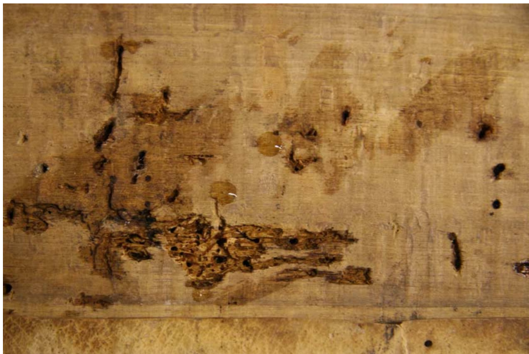
Obr.č.33 přední deska napadená červotočem
