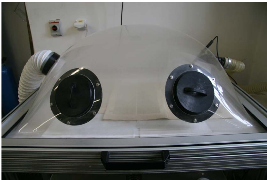
Obr.č.43 zvlhčování složek ve ultrazvukové zvlhčovací komoře
