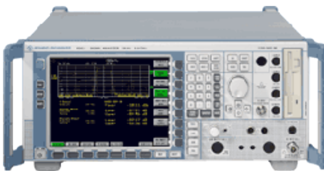
Obr. 17 Signální analyzátor Rohde & Schwarz FSQ3, 20Hz až 3 GHz
