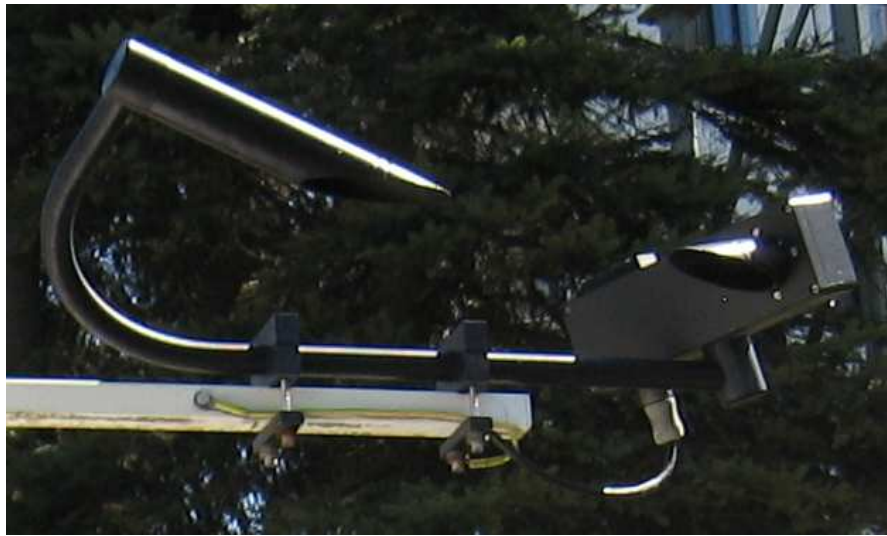
Obr. č.8: Dohledoměr Vaisala PWD21 na Milešovce
