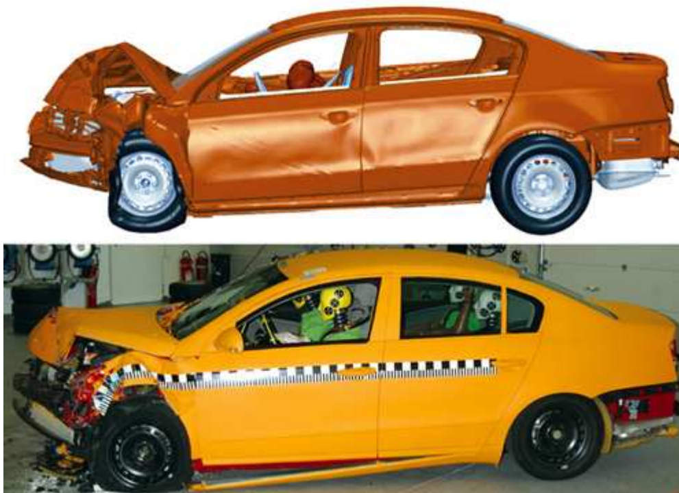
Obrázek 6: Porovnání počítačové simulace nárazu se skutečným crash-testem Zdroj: [11]
