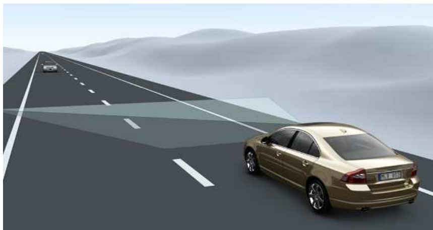
Obrázek 31: Systém DAC udržující vozidlo ve správném směru a zároveň sledující řidičovu pozornost Zdroj: VolvoCars
