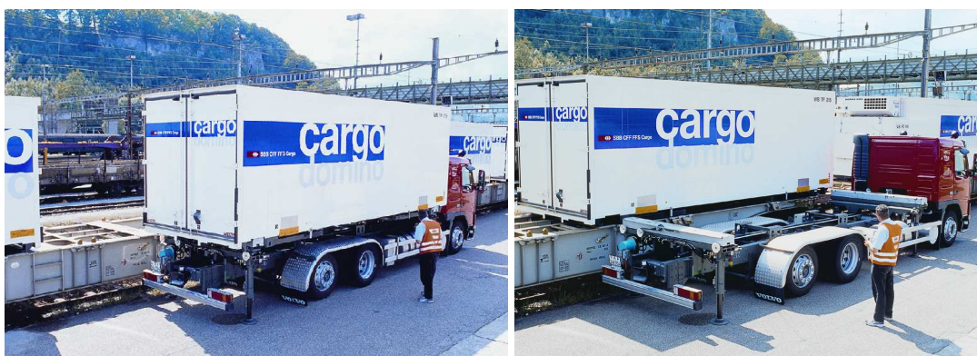
Obrázek 8 Mobiler - silniční vozidlo se zařízením pro horizontální překládku
