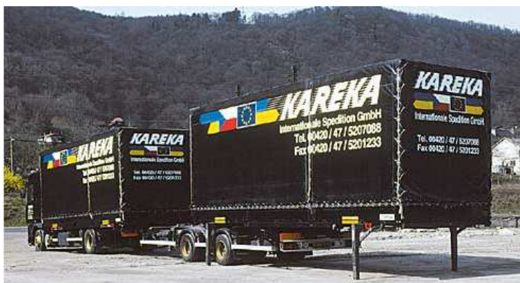
Obrázek 11 Jízdní souprava s kapacitou dvou výměnných nástaveb
