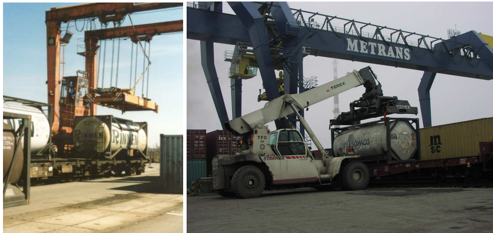
Obrázek 7 Technologie překládky pomocí portálového a samohybného jeřábu
