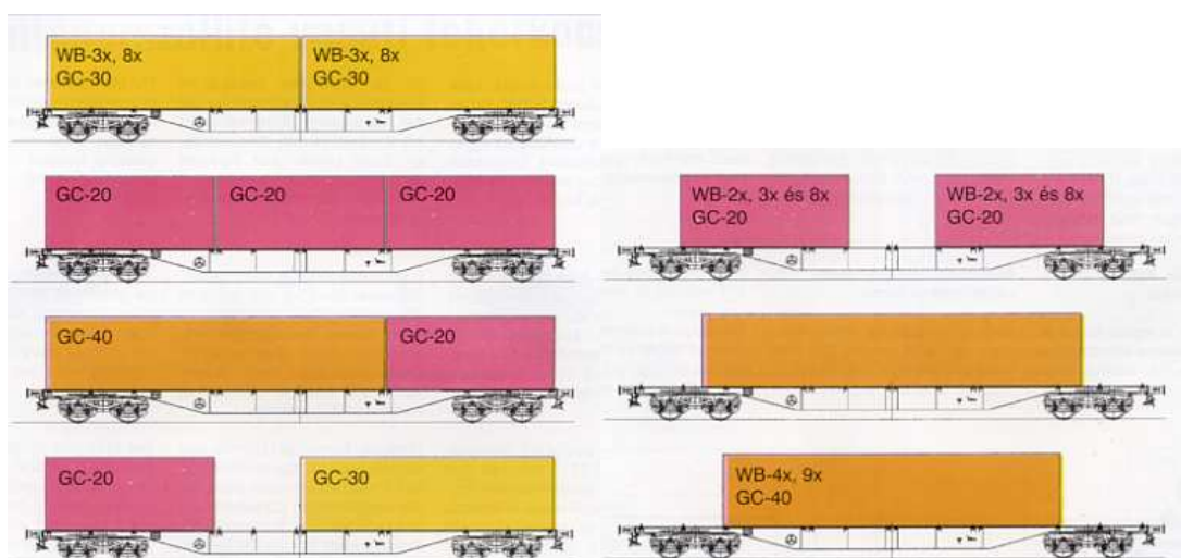
Obrázek 6 Umístění kontejnerů na železniční vůz v různých kombinacích
