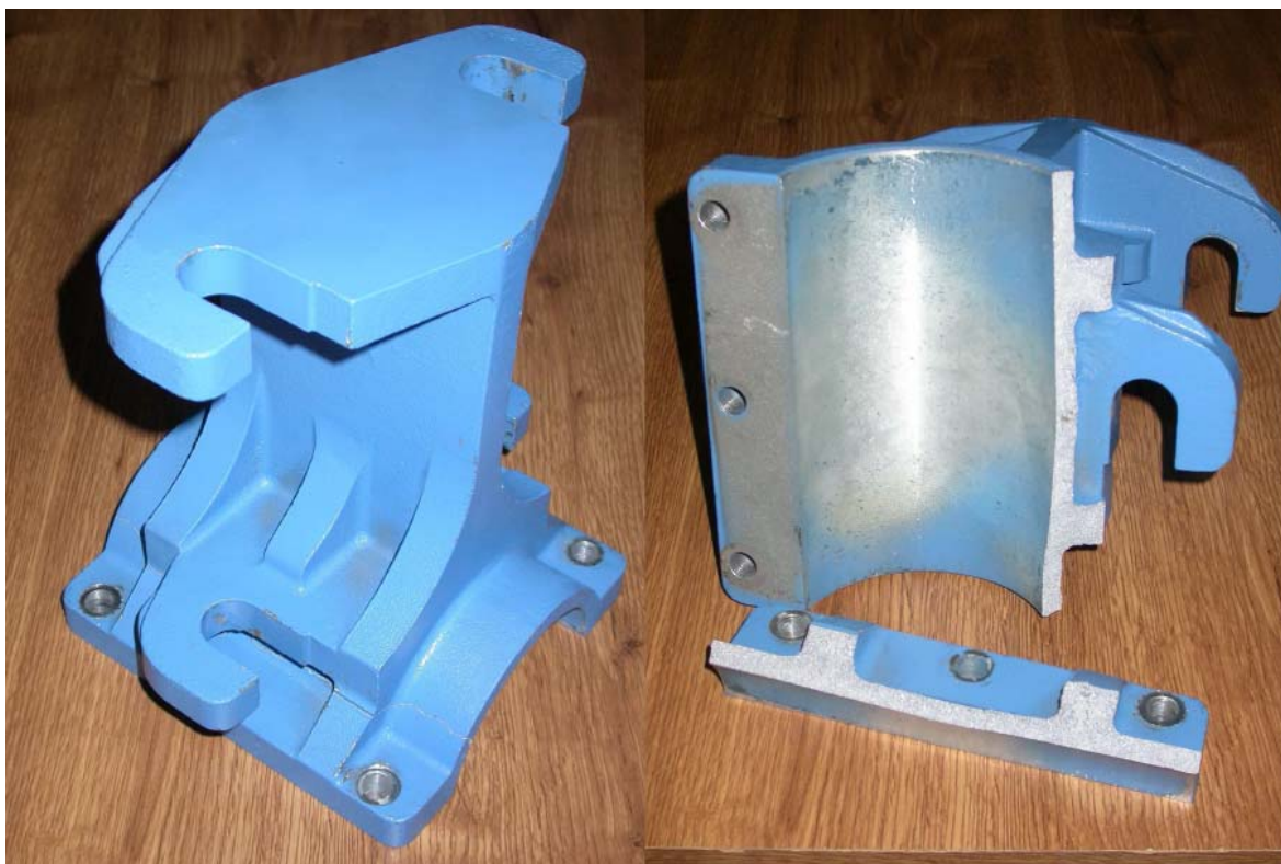
Obr. 1 Lom na horní části úchyty výdejního ramene
