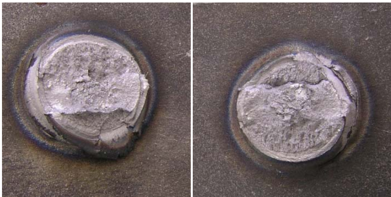
Obr. 4 Ukázka bodového svaru prvotního experimentu po destruktivní zkoušce
