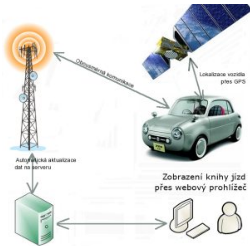
Obrázek č. 7 Princip činnosti GPS
