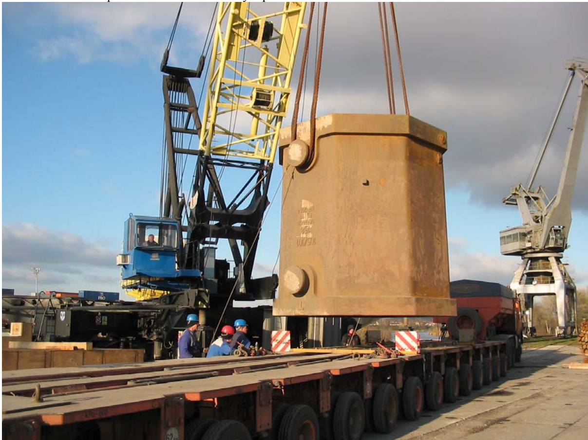
Obrázek 22: Průběh překlady 136 t těžké kokily v přístavu Mělník
