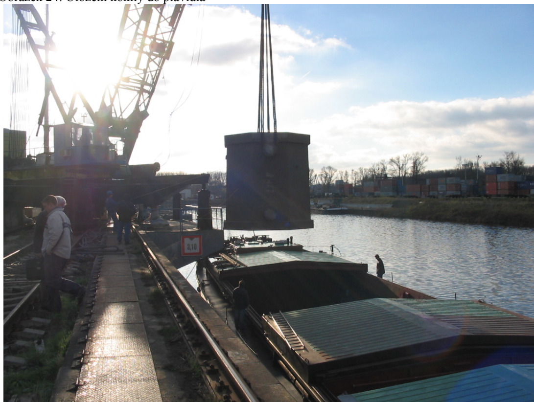
Obrázek 24: Uložení kokily do plavidla
