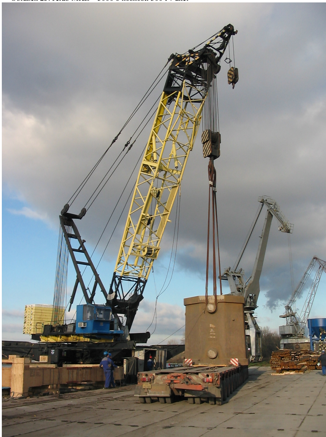
Obrázek 23: Jeřáb MKZ – 3000 o nosnosti 300 t v akci
