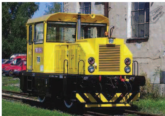
Obr. 29 Kapotáž lokomotivy řady 797.8 s motorem Caterpillar C9
