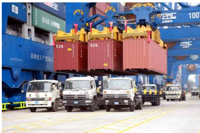
Obrázek č. 2: Trojitý leader pro tři kontejnery délky 40' nebo šest 20'
