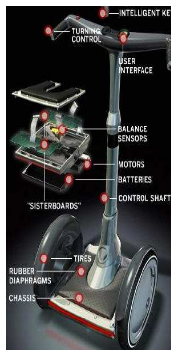
Obr.5b Části Segway [ 4 ]
