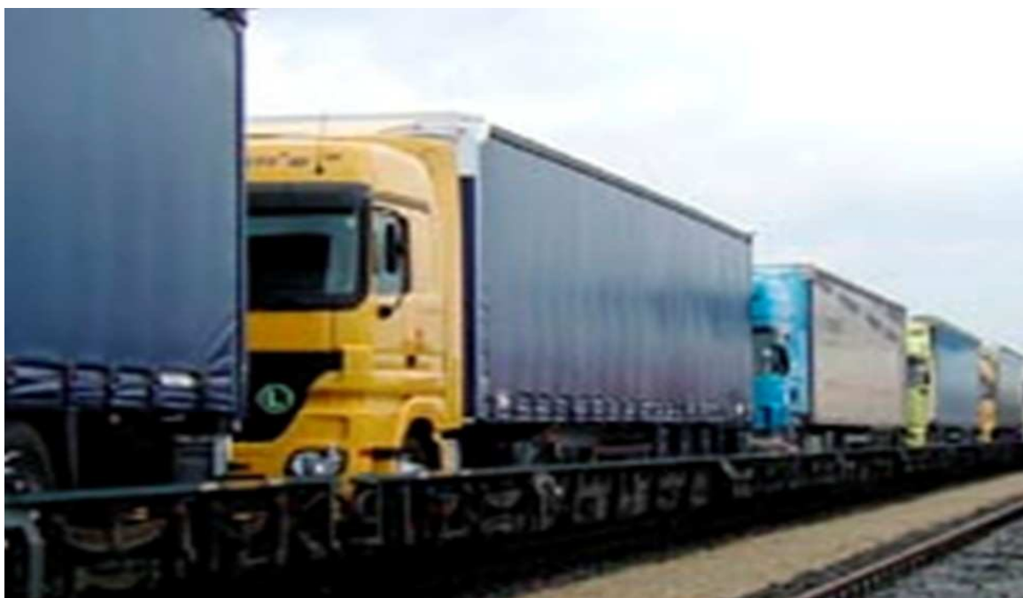
Obr. 3 – Přeprava silničních návěsů na železničních vozech
