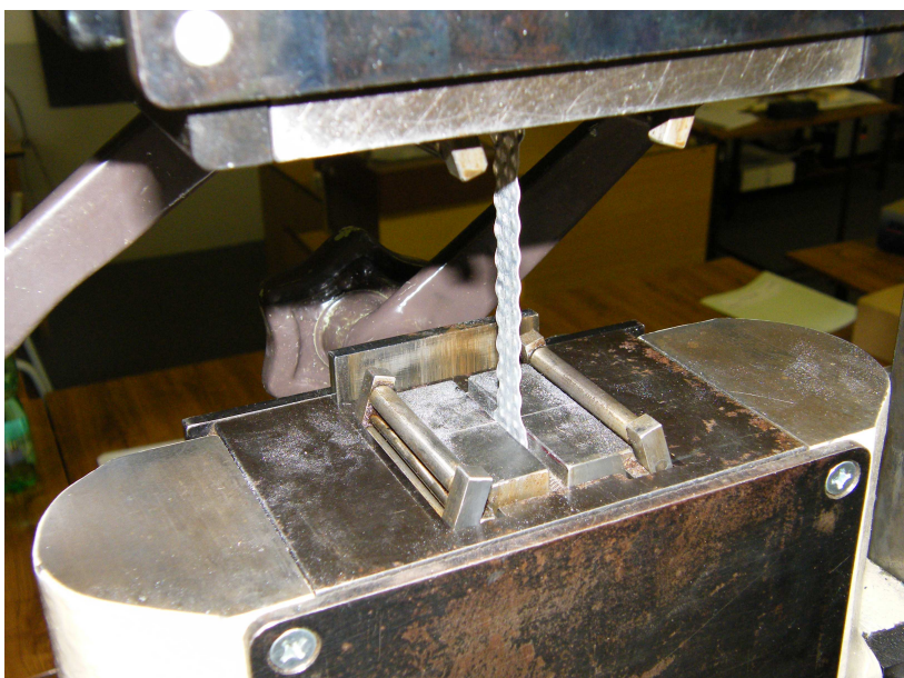
Obrázek č. 22: Čelisti trhačky s upnutou zkušební tyčí
