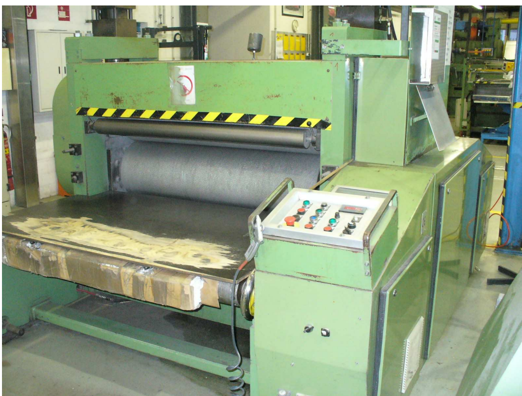
Obrázek č. 16: Nopkovací stolice UMT 406 (UniMaTec GmbH)
