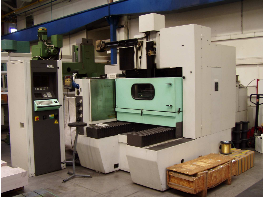
Obrázek č. 19: Drátovka AGIECUT 370 (AGIE Losone - Locarno, Švýcarsko)
