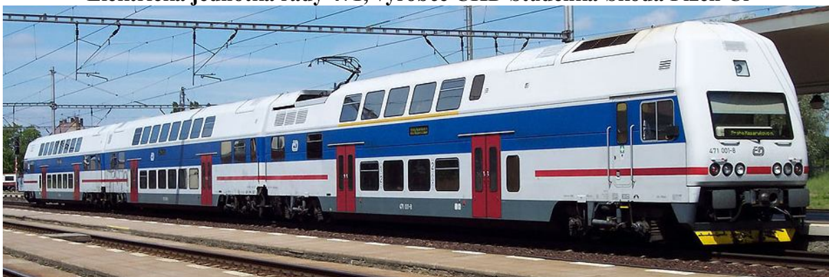
Elektrická jednotka řady 471, výrobce ČKD Studénka-Škoda Plzeň ČR
