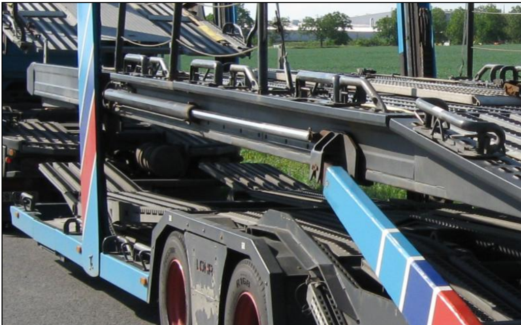
Obrázek 4: Hydraulické ovládání podlahy
