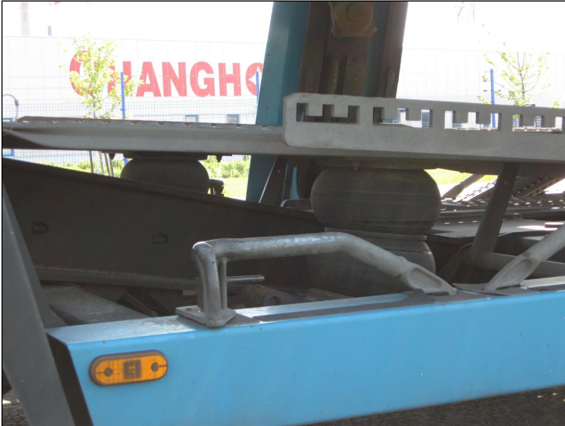
Obrázek 3: Pneumatické ovládání podlahy
