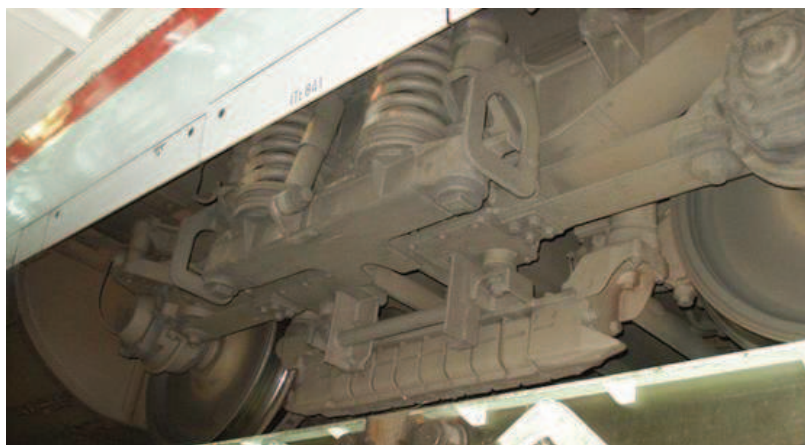
Obr. 7 Magnetická kolejnicová brzda v podvozku jednotky ICE-1 ( www.ice-fanpage.de )
