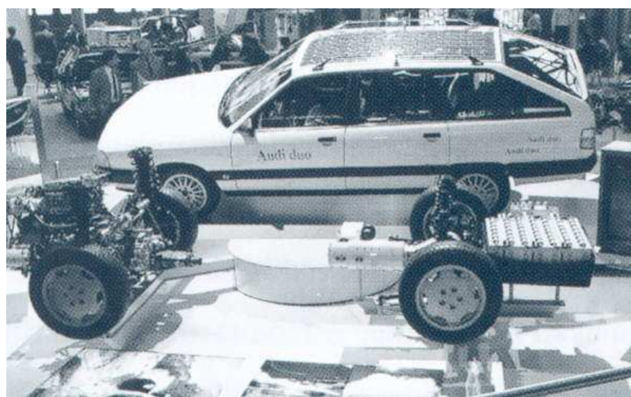
Obr. 2.5 Vpředu podélně uložený motor s převodovkou pro pohon přední nápravy a vzadu elektromotor napájený z baterie pro pohon zadní nápravy [4]
