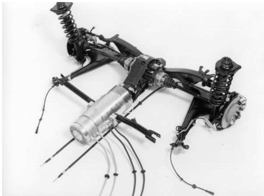
Obr. 2.6 Zadní nezávislé zavěšení typu McPherson spolu s diferenciálem a elektromotorem [4]
