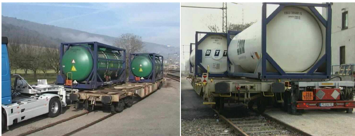
Obrázek 11 Překládka pomocí silničního překladače Mobiler
