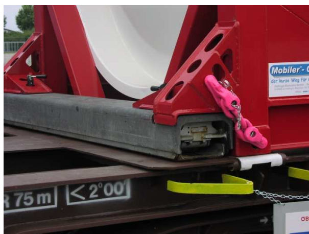
Obrázek 12 Překládací lyžina na příčném pásu železničního vozu
