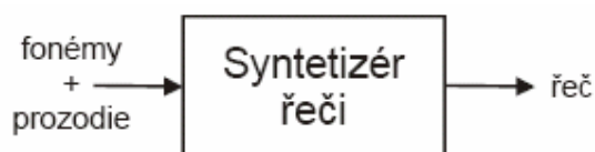
Obr. 4 Zjednodušené schéma typického syntetizéru, zdroj: [5]
