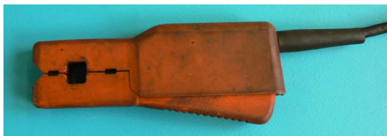
Obr.10: Kleště ke zjišťování otáček motoru
