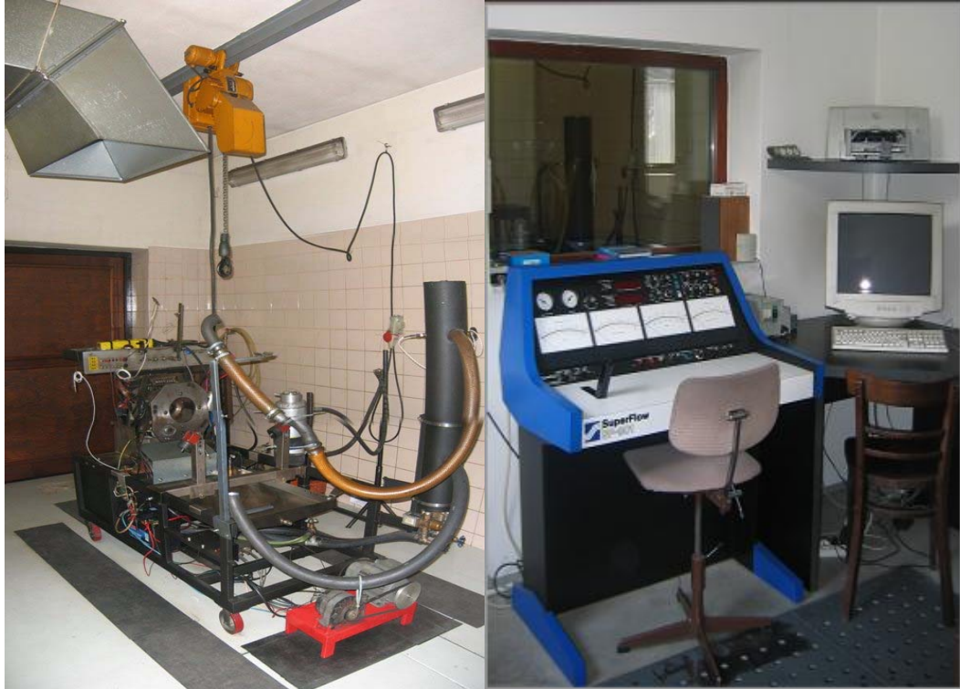
Obr.3: Motorová brzda s řídicím stanovištěm [9]
