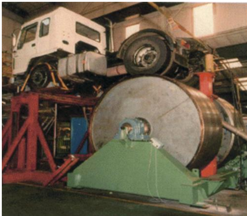
Obr.7: Výkonová válcová zkušebna pro nákladní automobily [10]
