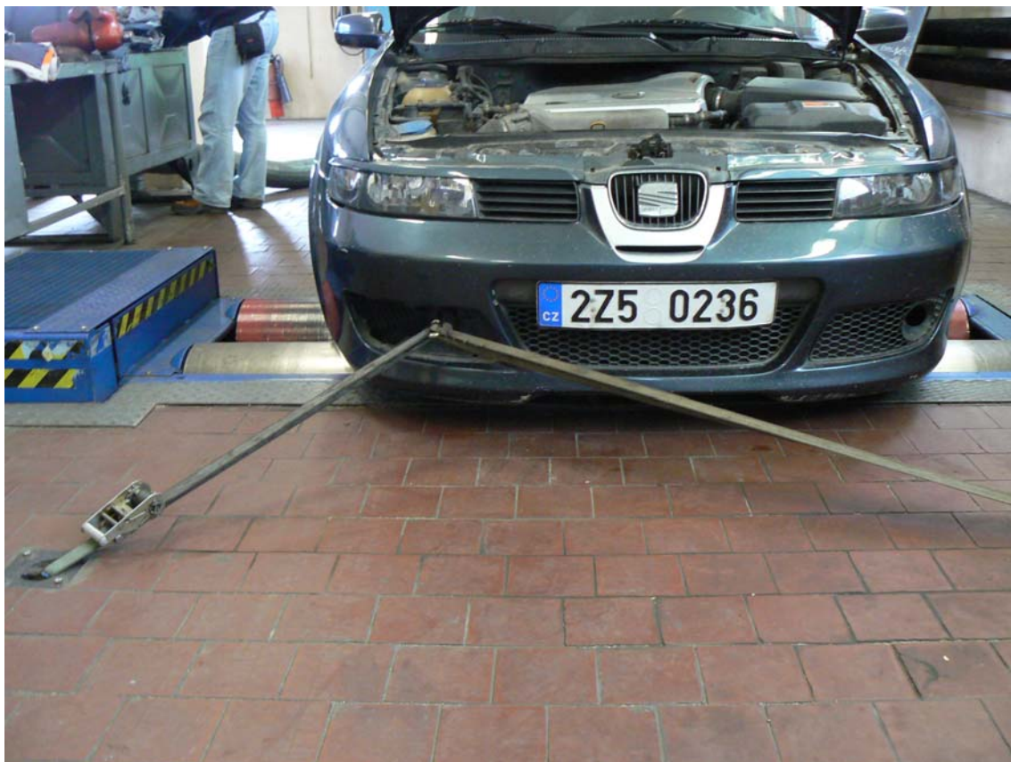
Obr.9: Ukotvení zkoušeného vozidla na válcích
