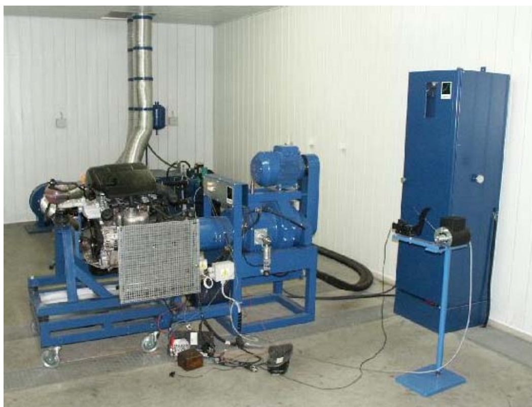
Obr.2: Motorová brzda pro měření výkonu [7]
