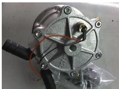
Obrázek 24: Reduktor pro kontinuální vstřík
