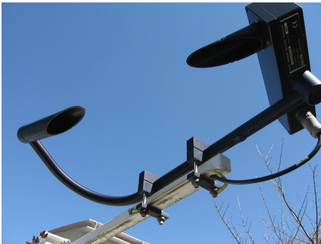
Obr. 8 Dohledoměr Vaisala PWD21 na Milešovce
