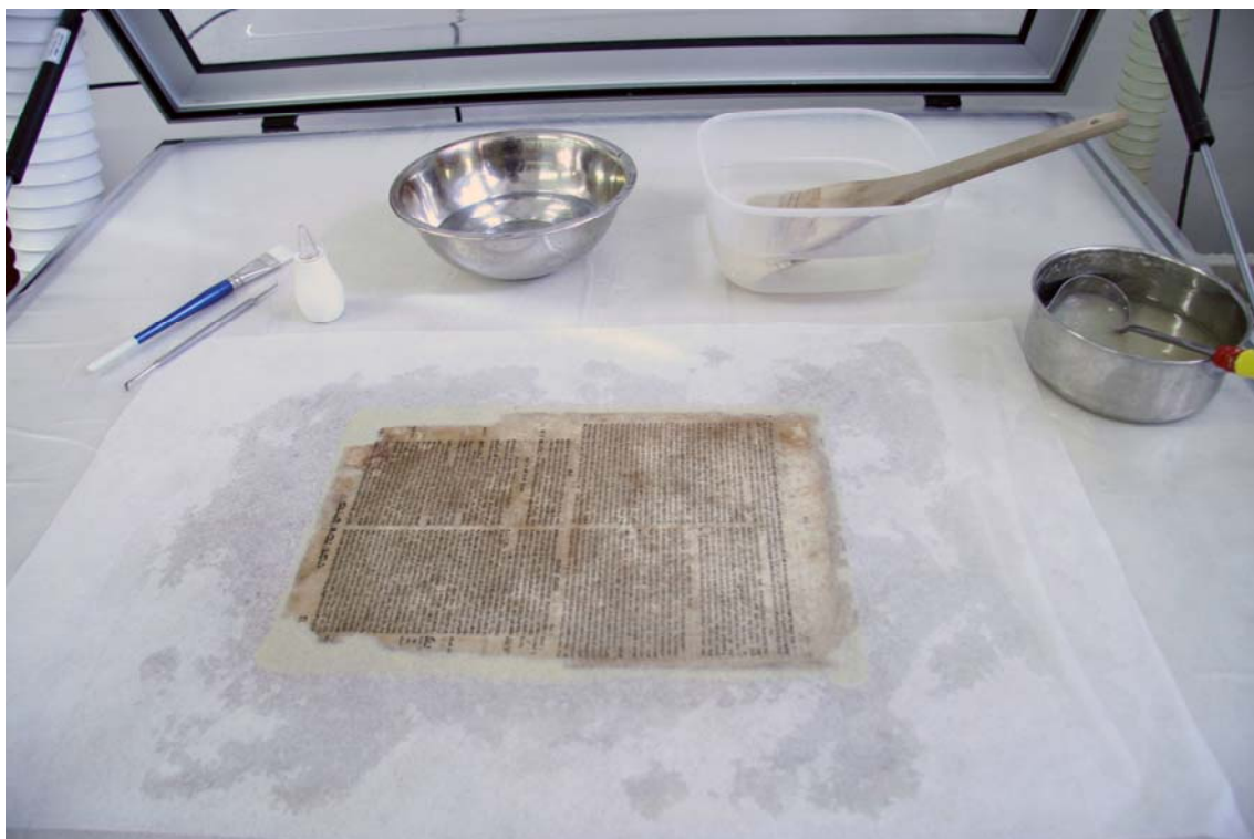
(Obr. 68) Vakuový dolévací stůl
