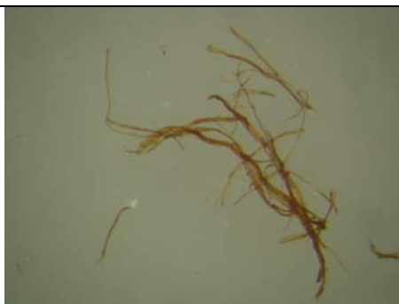
Standard – třída 1 podle R. Larsena Bílé procházející světlo, foceno při zvětšení mikroskopu 50x
