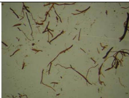
Standard třída 3 podle R. Larsena Bílé procházející světlo, foceno při zvětšení mikroskopu 50x
