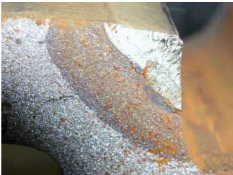
Obr. 2: Lomová plocha poškozené tramvajové kolejnice s dobře patrnými podnávarovými trhlinami, tmavým pásem a závěrečným dolomením.
