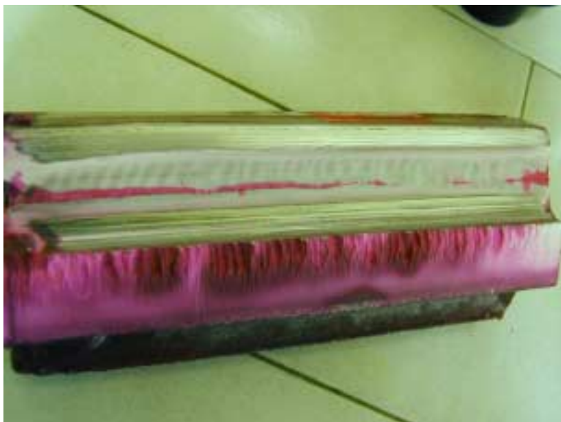
Obr. 3: Podélné trhliny v oblasti pod návarem nad dnem žlábků tramvajové kolejnice po provedené kapilární zkoušce.
