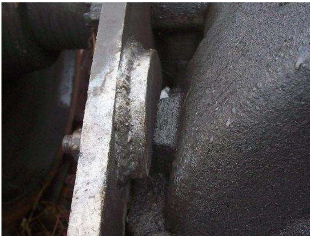
Obr.:10. Navařená zarážka na torzní vzpěře, přišroubovaná na skříň nápr. převodovky
