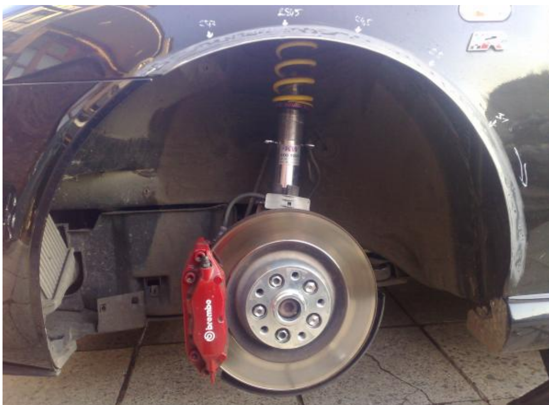
Obr. 2.2.2.2.b. Proces vytahování blatníků Audi A6:
