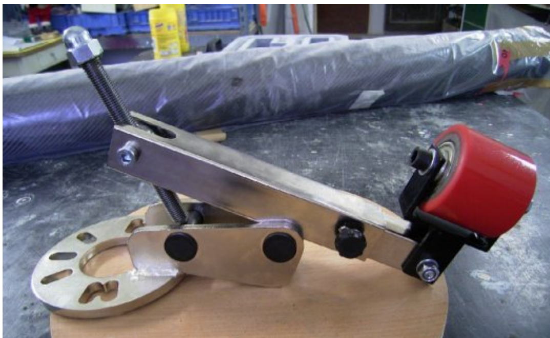
Obr. 2.2.2.2.b. Proces vytahování blatníků Audi A6:
