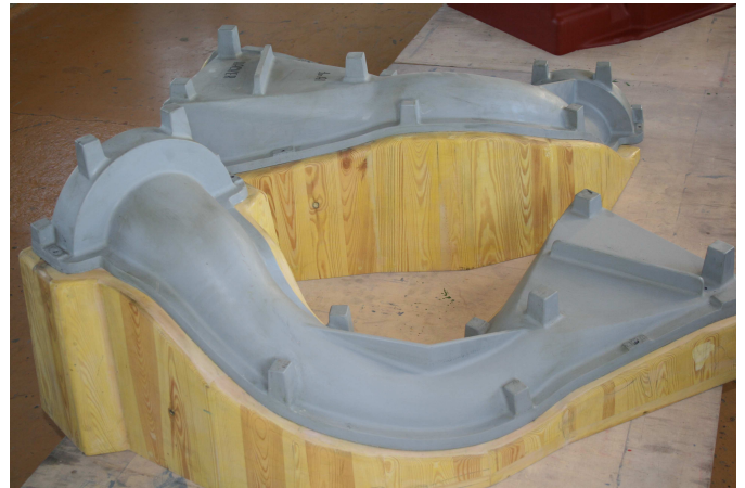
Skořepinový model spádového potrubí pro potravinářský průmysl
