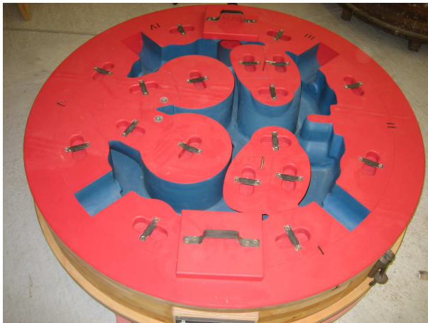
Jaderník pro hlavu lodního motoru
