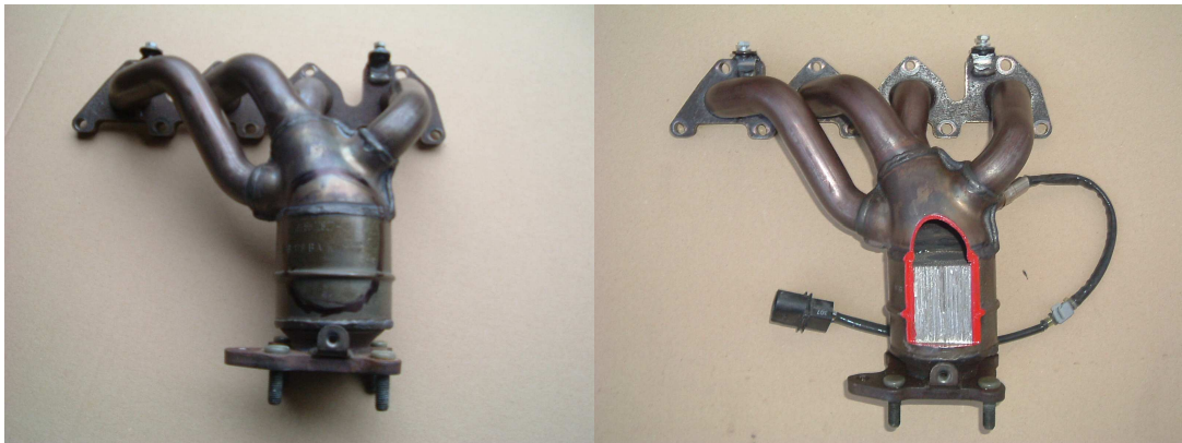
Obr. 3.3.d. Řez výfukovým sběrným potrubím
