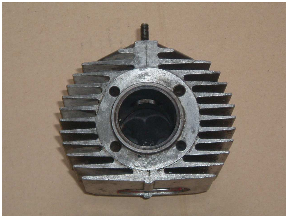
Obr. 6.3.b. Válec vzduchem chlazeného motoru Jawa 50
