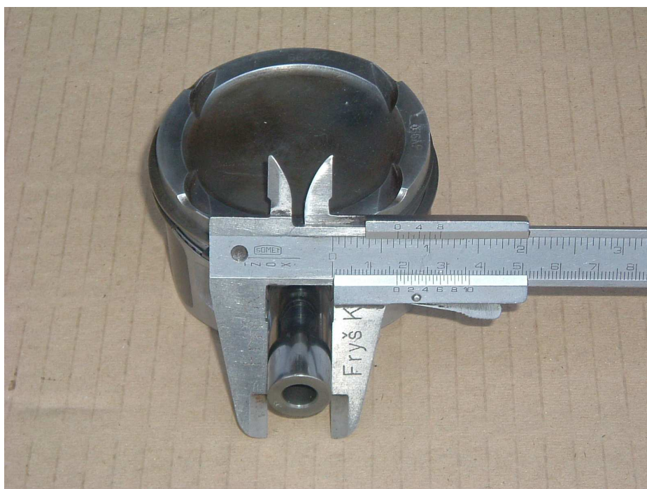
Obr. 4.1.f. Měření průměru pístního čepu
