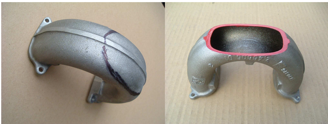
Obr. 3.3.c. Řez sacím potrubím
