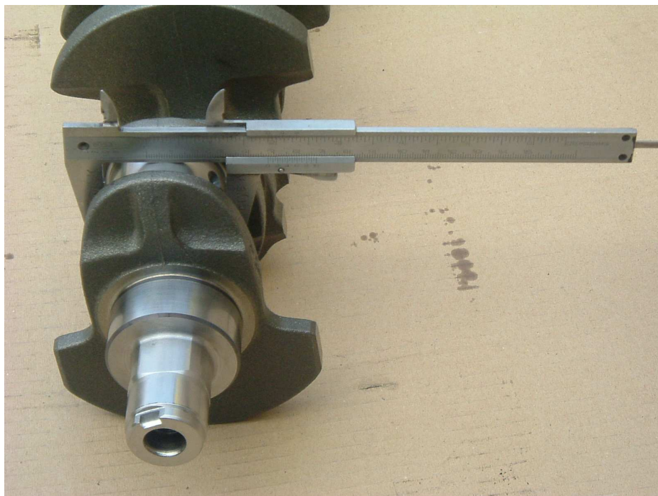
Obr. 4.1.c. Měření průměru ojničního čepu klikového hřídele
