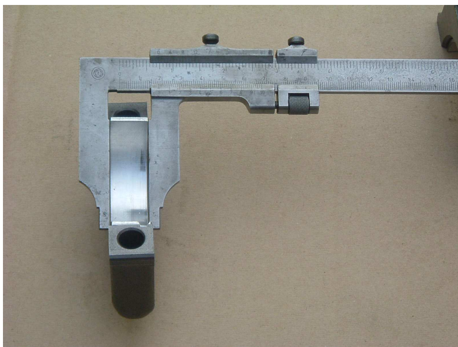
Obr. 4.1.d. Měření šířky hlavní pánve ložiska
