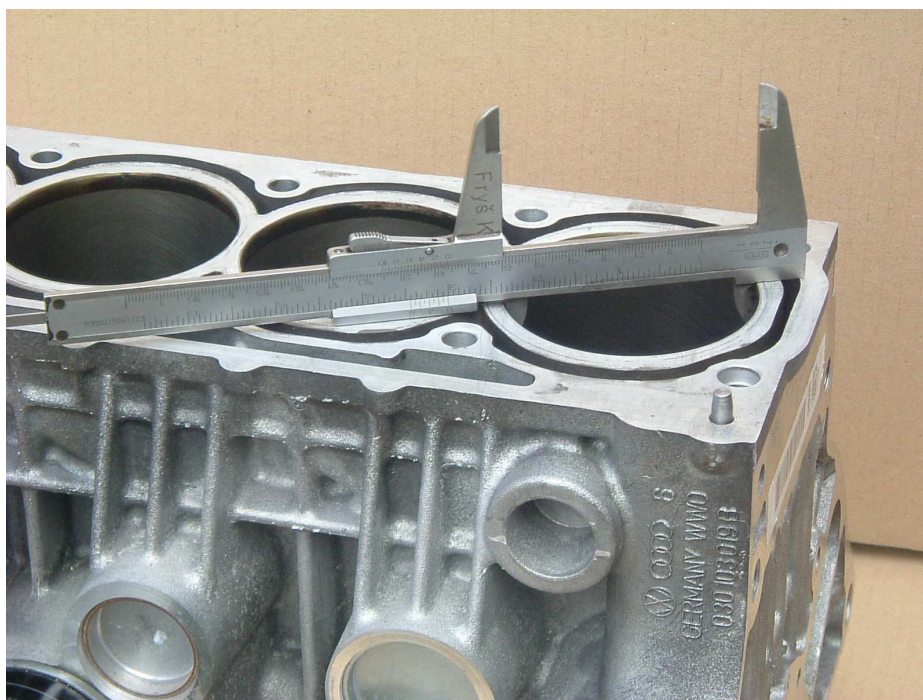
Obr. 4.1.a. Měření vrtání válce
