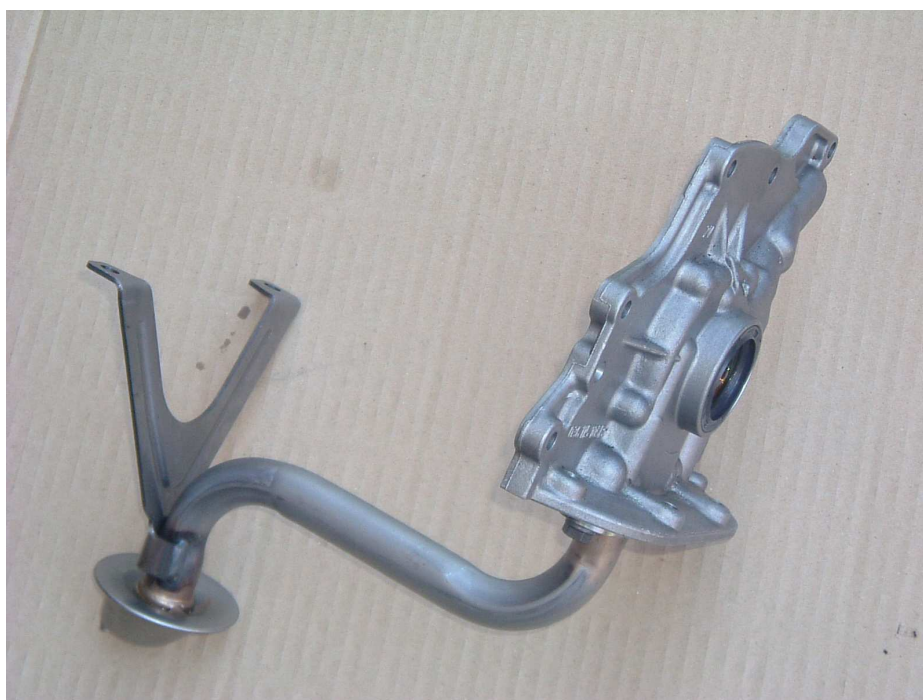
Obr. 6.5.c. Přední víko motoru, které zároveň plní funkci olejového čerpadla
