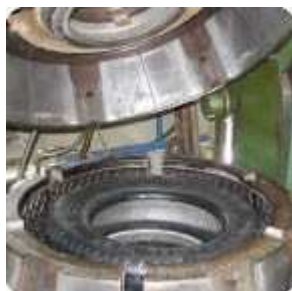
Obrázek 6: Protektorování technologií "za tepla v lisu"
