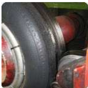
Obrázek 6: Protektorování technologií "za tepla v lisu"
