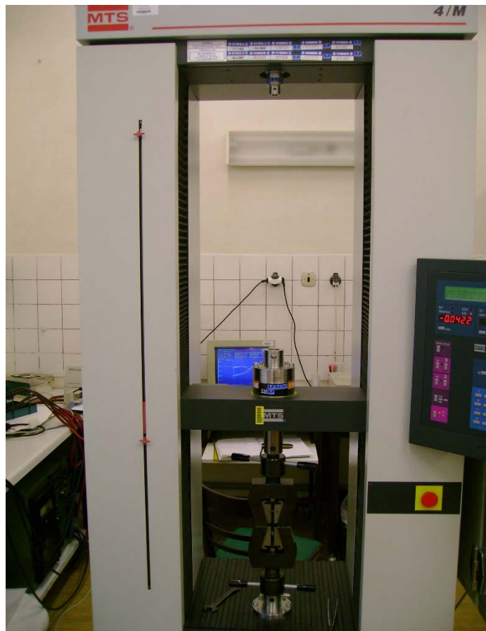
Obr. 4.6. Zkušební trhací přístroj MTS 4/M
