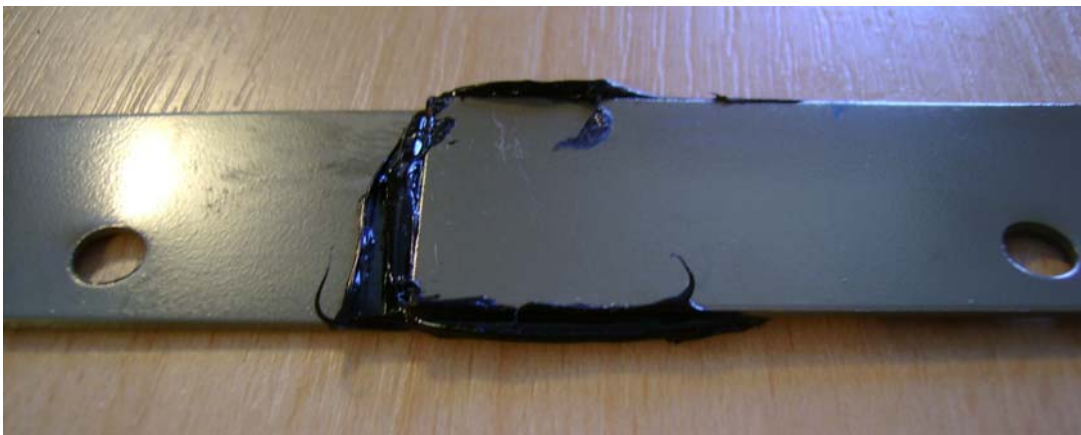
Obr. 4.4. Spojení obou zkušebních tělíekí a následné vytlačení zbytkového lepidla
