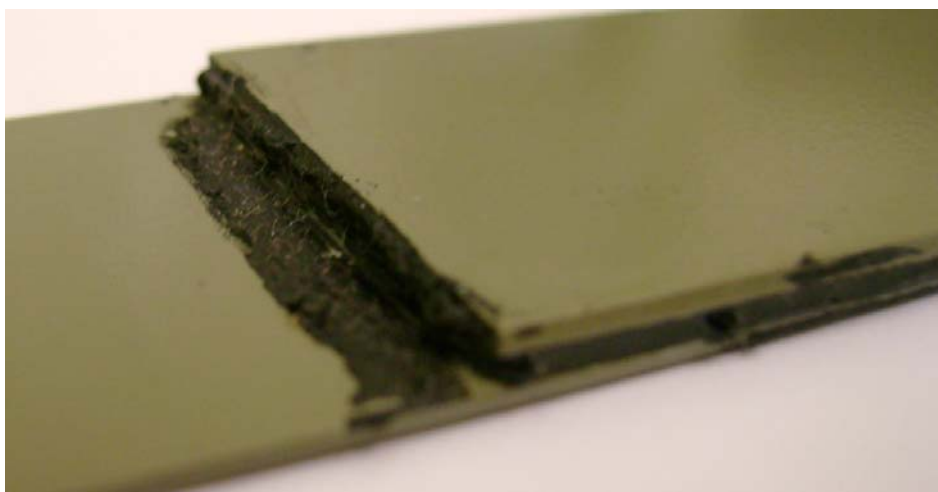
Obr. 5.1 Spoj po přetržení se opět vrátil do původního stavu
