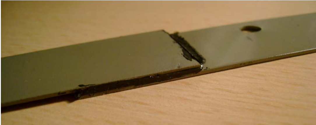
Obr. 4.5. Spoj s ořezaným přebytečným lepidlem
