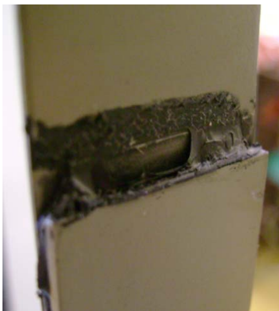
Obr. 5.3 Přetrhávání lepidla během zkoušky
