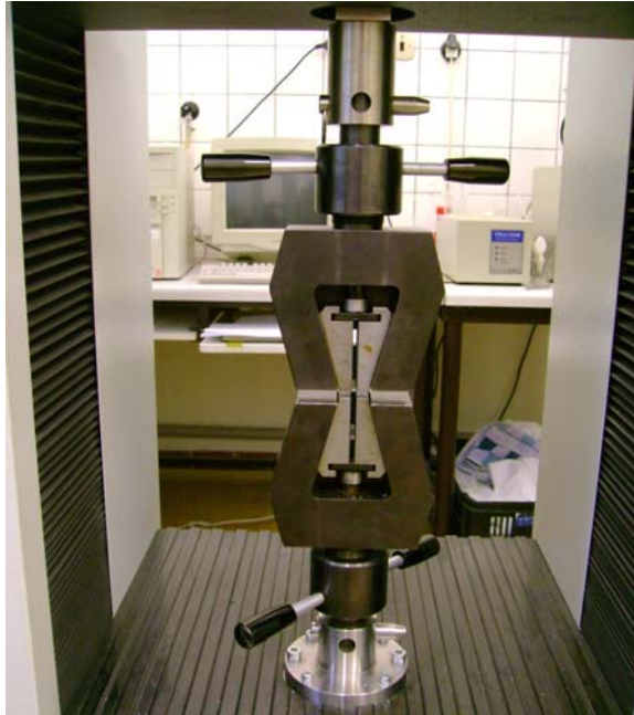
Obr. 4.7. Trhací hlavice pracující až do hodnoty 20 kN
