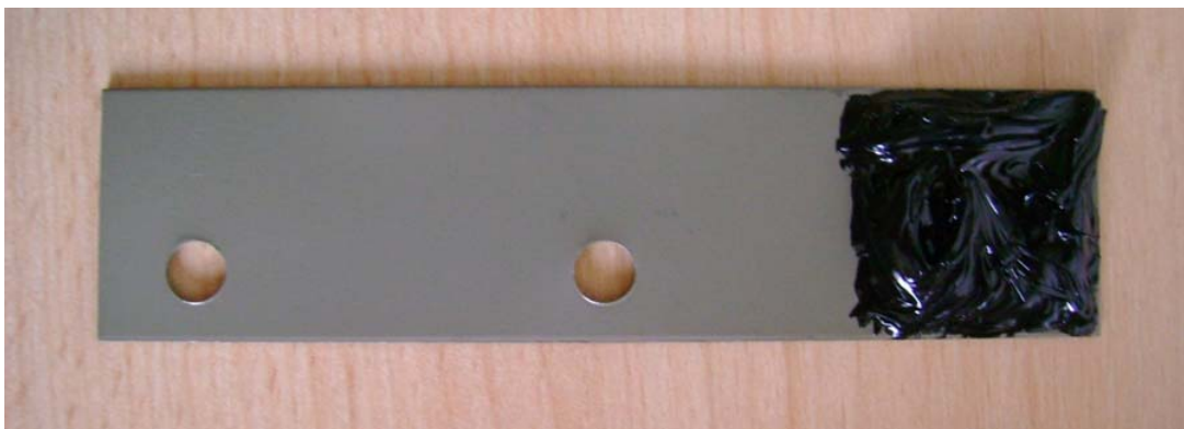
Obr. 4.3. Nanesené lepidlo na zkušební těleso
