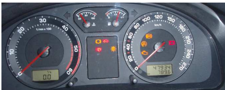
Obr. 19 – Ukázka signalizace nečinnosti (závady) systému ABS
