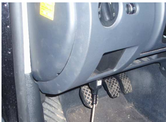
Obr. 20 – Ukázka připojení diagnostického zařízení
