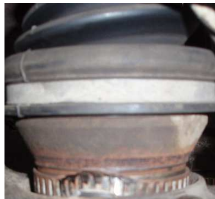
Obr. 25 – Příčina poškození snímače
