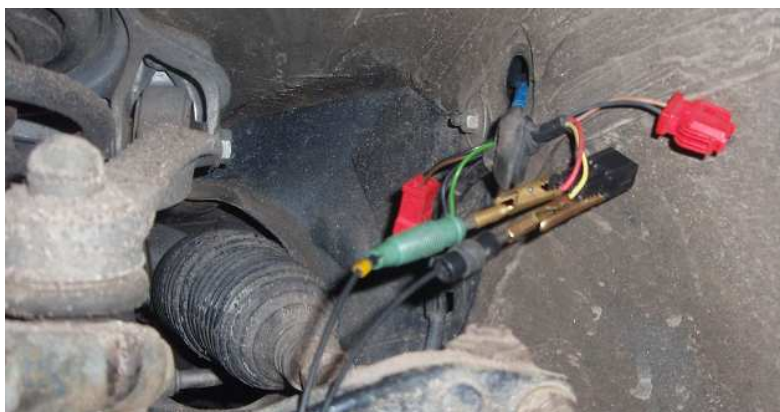
Obr. 22 – Napojení osciloskopu pro kontrolu snímače LP
