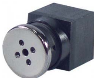
Obrázek 6 - Miniaturní kamera maskovaná v knoflíku [1]
