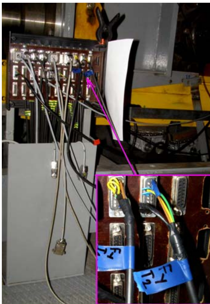
obr. 19 Připojení kabelů F_{TY1} a F_{TY2} do konektorového panelu
