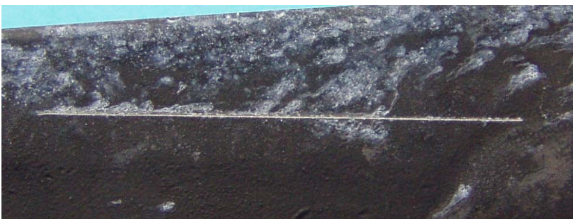
Obr. 42: Zkouška v solné mlze s vrypem po 288 hodinách
