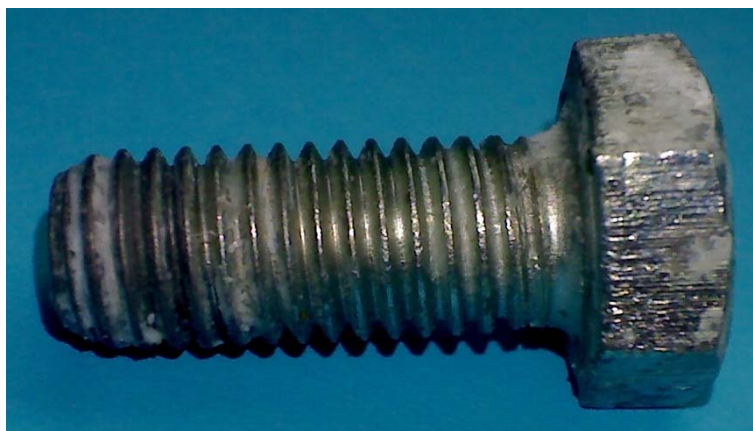
Obr. 41: Konečný stav vzorku „A“ po 288 hodinách v solné mlze
