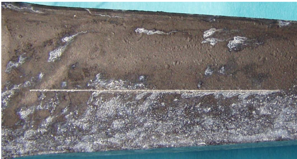
Obr. 43: Zkouška v solné mlze s vrypem po 480 hodinách
