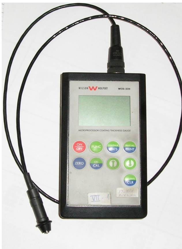
Obr. 16: Měřicí přístroj WCG 320 s indukční sondou
