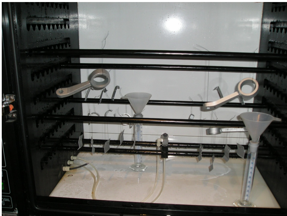
Obr. 23: Rozmístění vzorků v solné komoře
