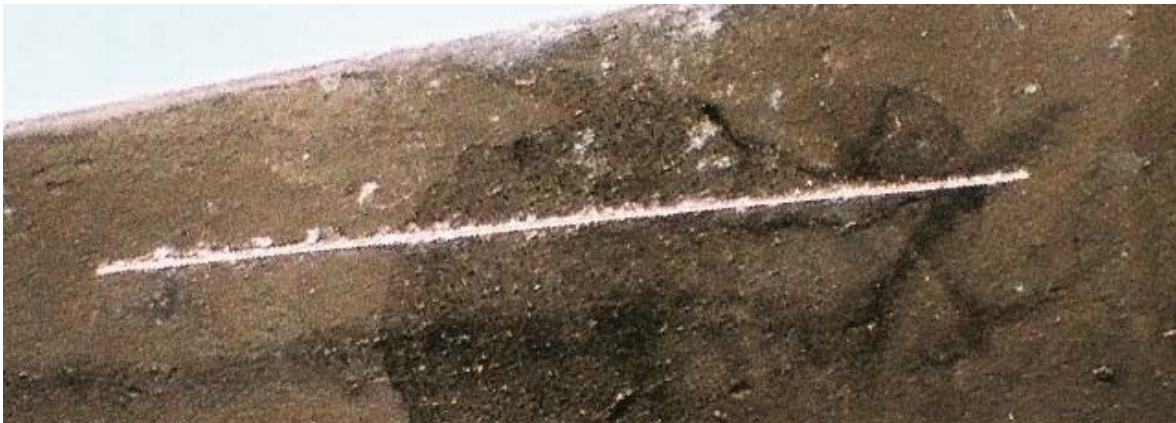
Obr. 40: Zkouška v solné mlze s vrypem po 110 hodinách
