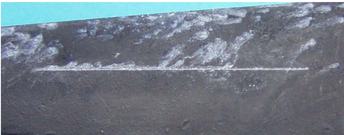
Obr. 41: Zkouška v solné mlze s vrypem po 192 hodinách
