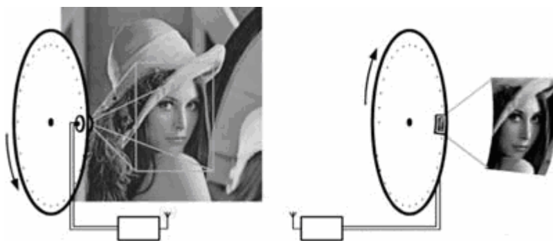
Obrázek 1 – Princip fungování Nipkowova kotouče [15]
