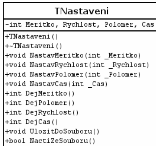
Obrázek 14. UML zobrazení třídy Nastaveni
