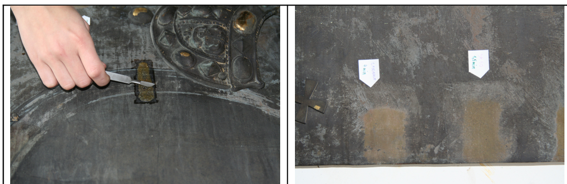
Obr. 26 Účinek iontoměničů na korozní produkty mědi. Deskový obraz Madonna s Ježíškem – restaurováno 2006
