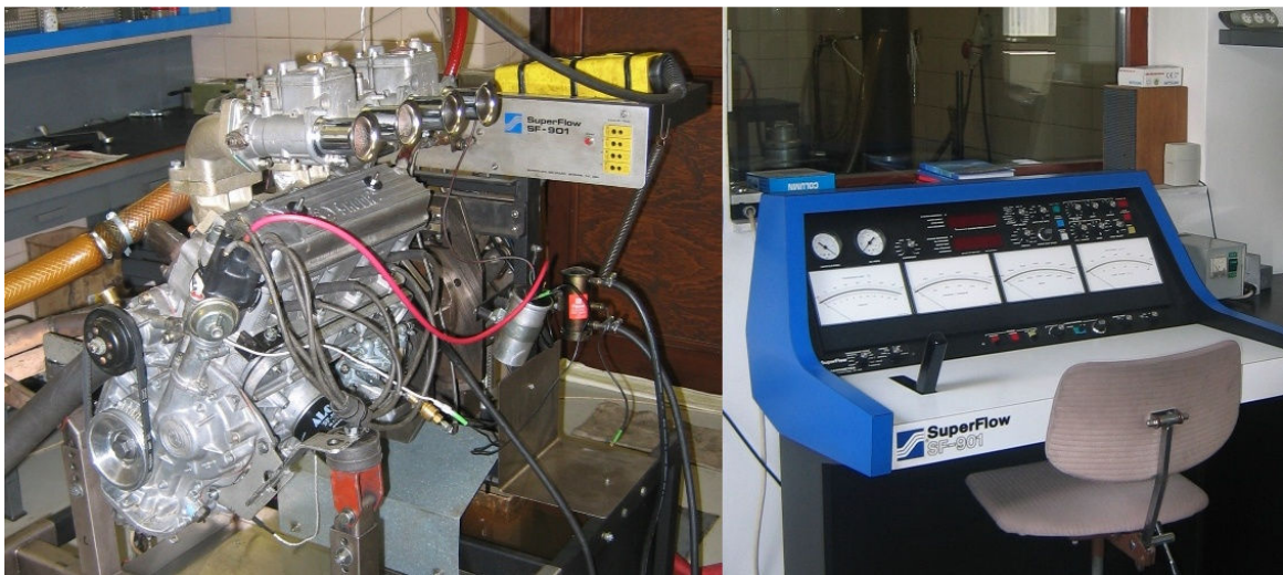
Obrázek 44 - Stanice na úpravu výkonu motorů
