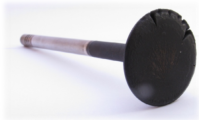
Obrázek 47 – demontovaný výfukový ventil
