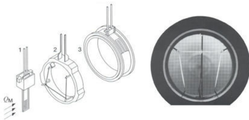
Obrázek 16 - Měřič množství vzduchu se žhaveným drátem [4]
