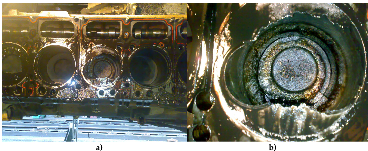
Obr. 32 - Poškozené části spalovacího motoru: a) tepelně poškozený blok motoru, b) pohled na utržené dno pístu
