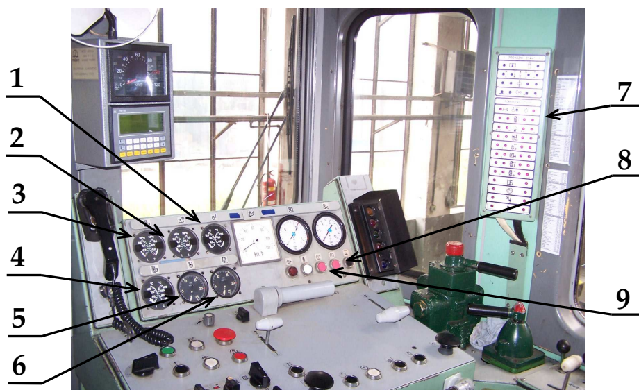
Obr. 35 – Stanoviště sériově vyrobeného vozu řady 842 s vyznačenými prvky sledování provozních stavů a diagnostiky poruch; 1 – teploty chladící kapaliny motorů, 2 – tlaky oleje motorů, 3 – tlaky oleje trakčních převodovek, 4 – teploty oleje trakčních převodovek, 5 – otáčky motorů řídicího vozu, 6 – otáčky motorů řízeného vozu, 7 – indikace poruchových stavů, 8 – signalizace sdužené poruchy, 9 – tlačítka vybavení (kvitace) sdužené poruchy.
