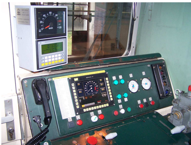
Obr. 43 – Pohled na stanoviště prototypového vozu po modernizaci řídicího systému.
