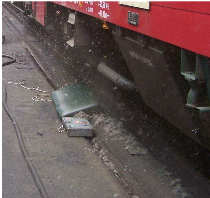
Obr. 41 – biologické nečistoty při čištění chladiče tlakovým vzduchem.
